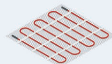
Calefacción por piso radiante
