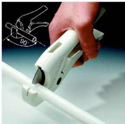
Fig. 23: Cortar el tubo de PE-Xb RAUBASIC con una tijera para tubos sin rebabas y en ángulo recto en la medida deseada. ¡Atención! Mantener la mano que sostiene el tubo a una distancia segura de la herramienta.
