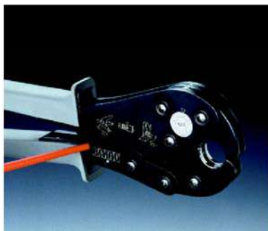
Fig. 22: Apertura de la herramienta en caso de emergencia.
